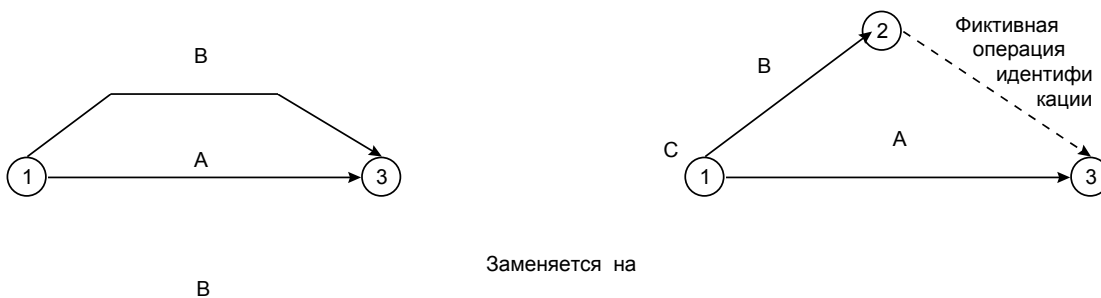
Рис. 9 Использование в стрелочном графе фиктивной операции идентификации
