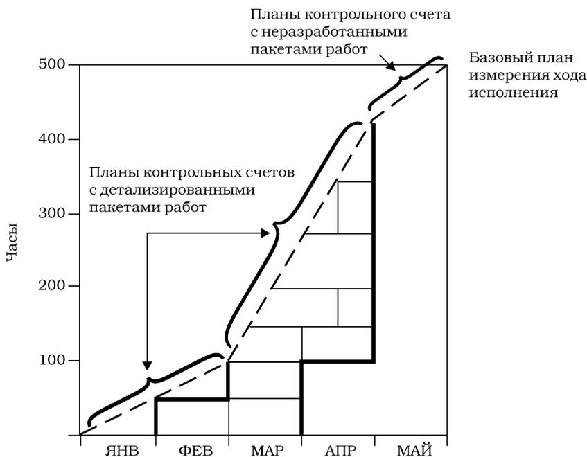
**Рис. 13.4.** Базовый план измерения хода исполнения: сумма планов контрольных счетов
