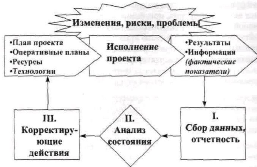
Рис. 4.1. Обобщенная схема процесса контроля исполнения проекта
