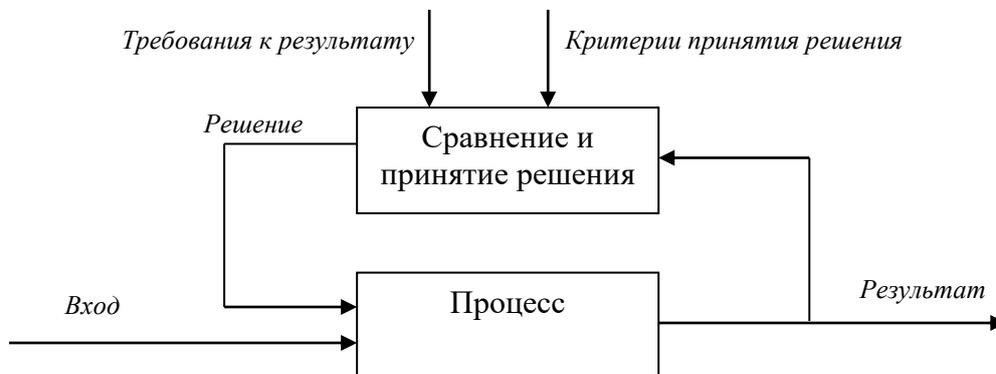
Рисунок 2. Механизм управления
