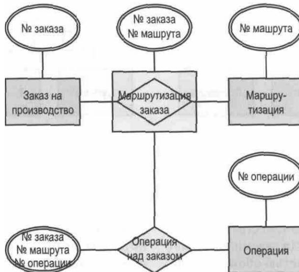
Рис. 118. Агрегация с переопределением типа отношений
