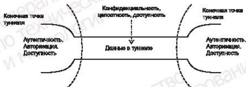
Рисунок 2 — Общие требования безопасности ВЧС, сопоставленные с базовым туннелем
