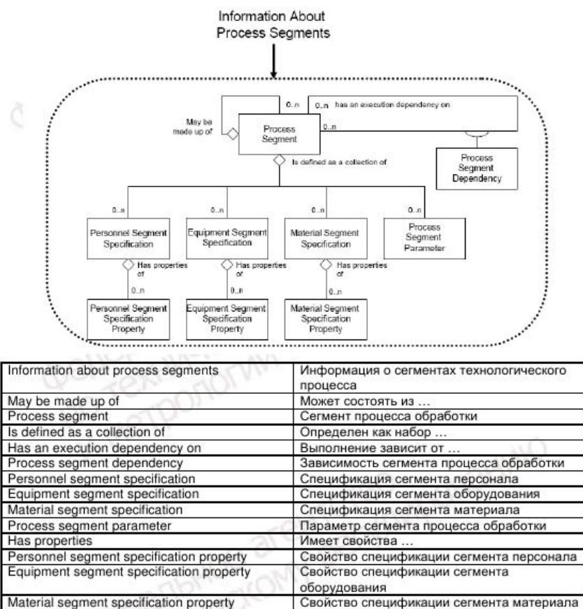
Рисунок 19 – Группировка объектов для модели сегмента процесса обработки
