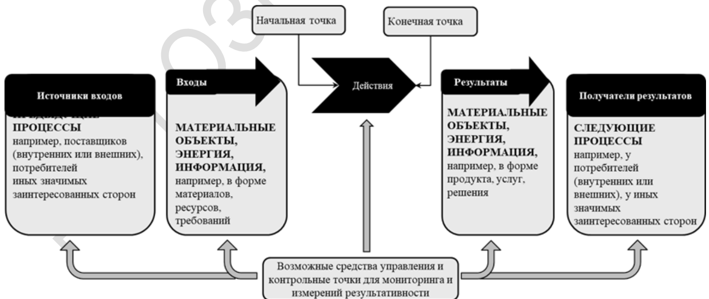
Рисунок 1 - Схематическое представление элементов одиночного процесса
